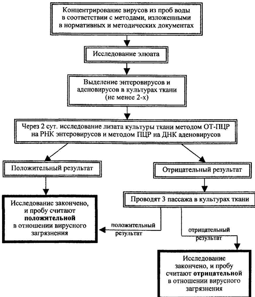
**Схема вирусологического контроля воды после обеззараживания УФ-обработкой**
