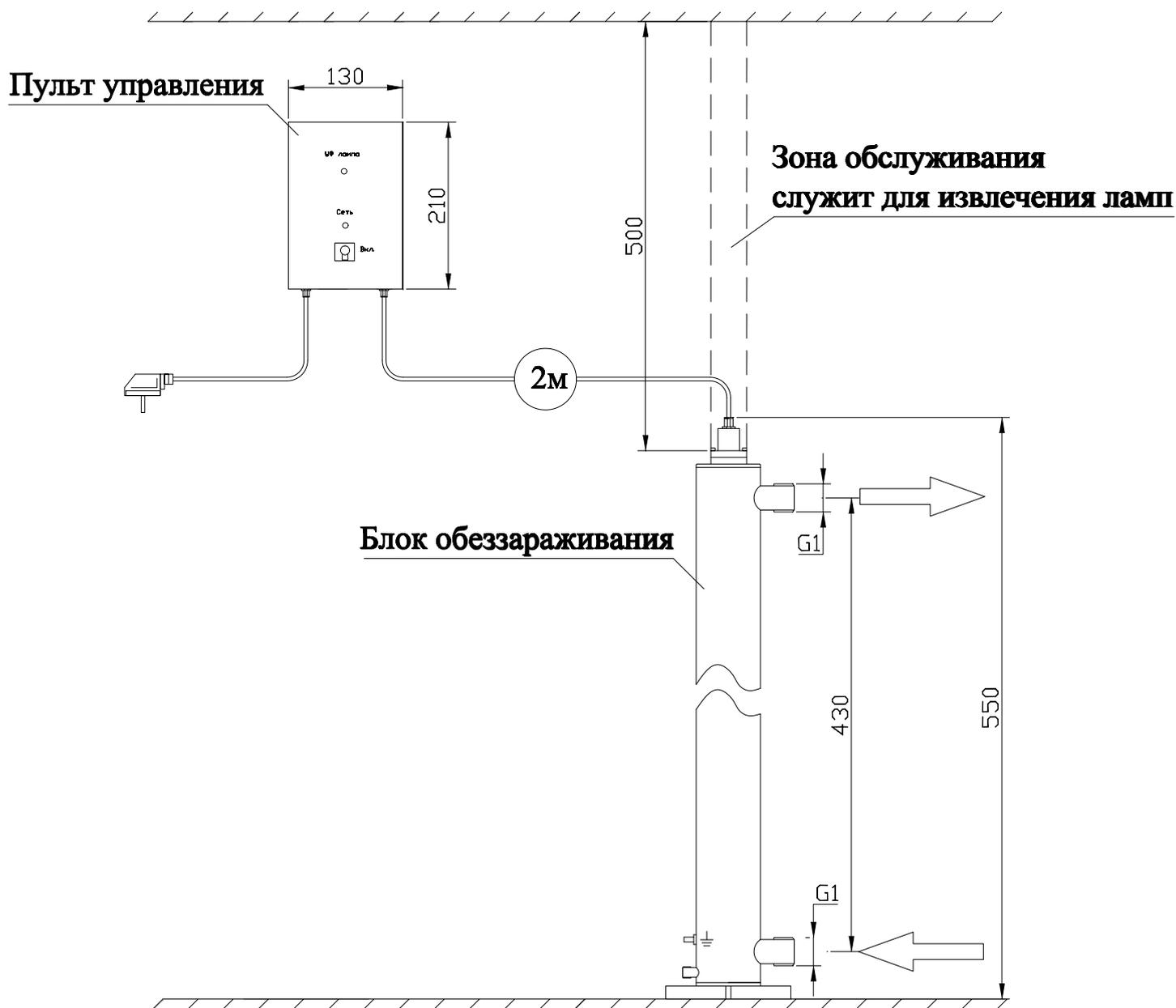
Примечание: монтаж установки к стене производится при помощи двух хомутов  $\text{Ø}80$  мм.
