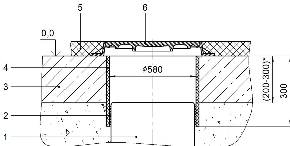
1 – переходник  $\text{Ø}1200/\text{Ø}560$ ; 2 – уплотнитель; 3 – разгрузочная железобетонная плита; 4 – кольцо опалубочное; 5 – дорожное покрытие; 6 – люк чугунный.
