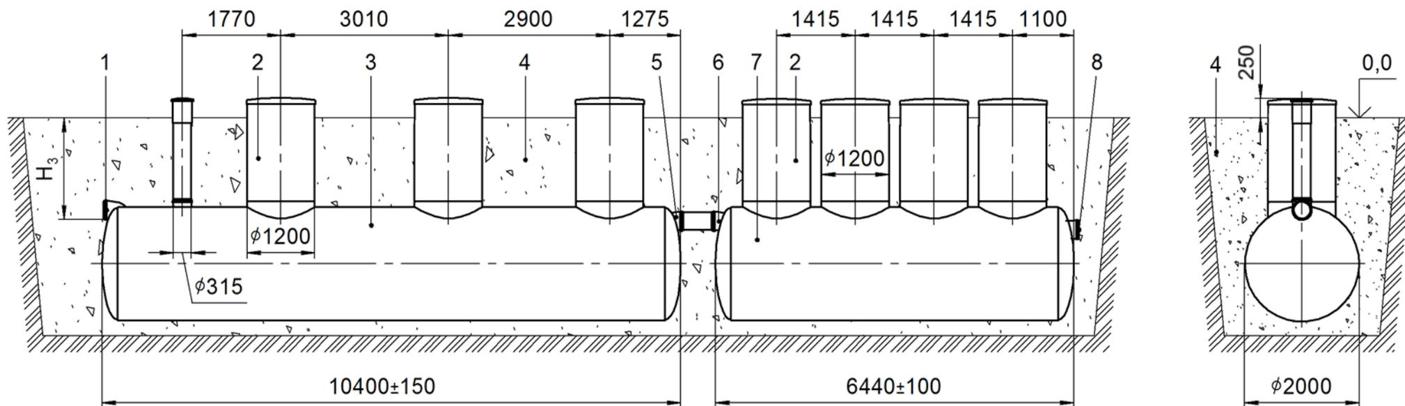
1 – патрубок входной блока ПН установки «Векса-45-М»; 2 – колодец технический с пластиковым люком; 3 – корпус блока ПН установки «Векса-45-М»; 4 – песок уплотнённый; 5 – патрубок выходной блока ПН установки «Векса-45-М»; 6 – патрубок входной блока СМ установки «Векса-45-М»; 7 – корпус блока СМ установки «Векса-45-М»; 8 – патрубок выходной блока СМ установки «Векса-45-М».
