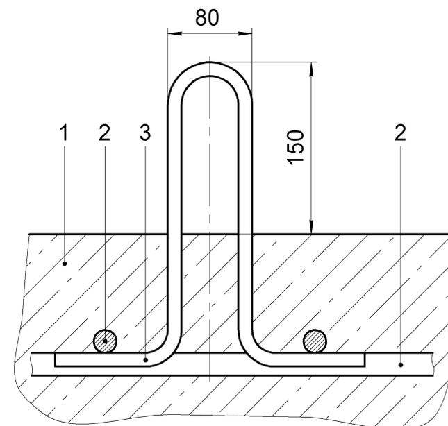
1 – фундаментная железобетонная плита; 2 – арматура фундаментной железобетонной плиты; 3 – закладная деталь (арматура класс АIII  $\text{Ø} 12$  мм).
